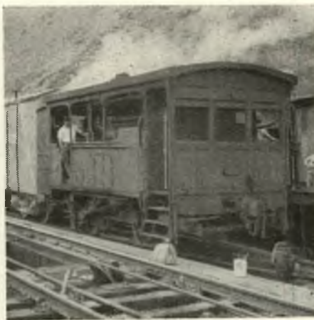
O vagão-breque, prêso aos cabos, puxa a composição fracionada.
