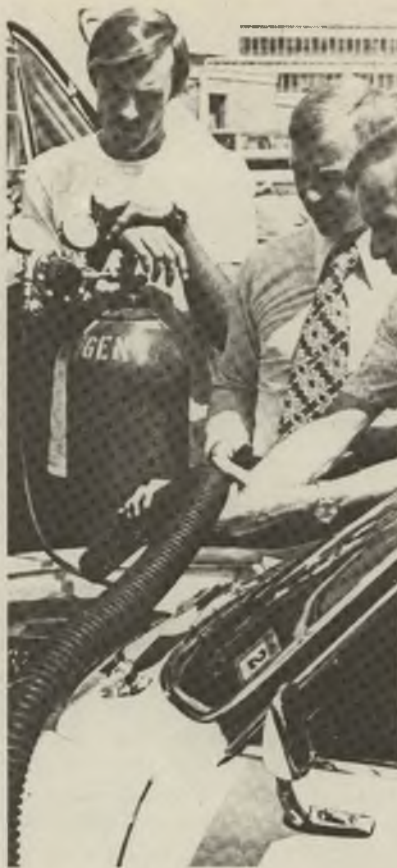
Roger explica a colegas seus como o carburador alimentado a hidrogênio queima as partículas (ou fumaça) e as expelle pelo sistema exaustor. (Foto por cortesia de Hal Williams).
